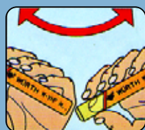
Rasina trebuie sa aiba fluiditatea mierii
