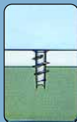
Insurubarea completa a diblului
