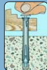
Montare capacel ornamental (la Tip WUS-SK).
